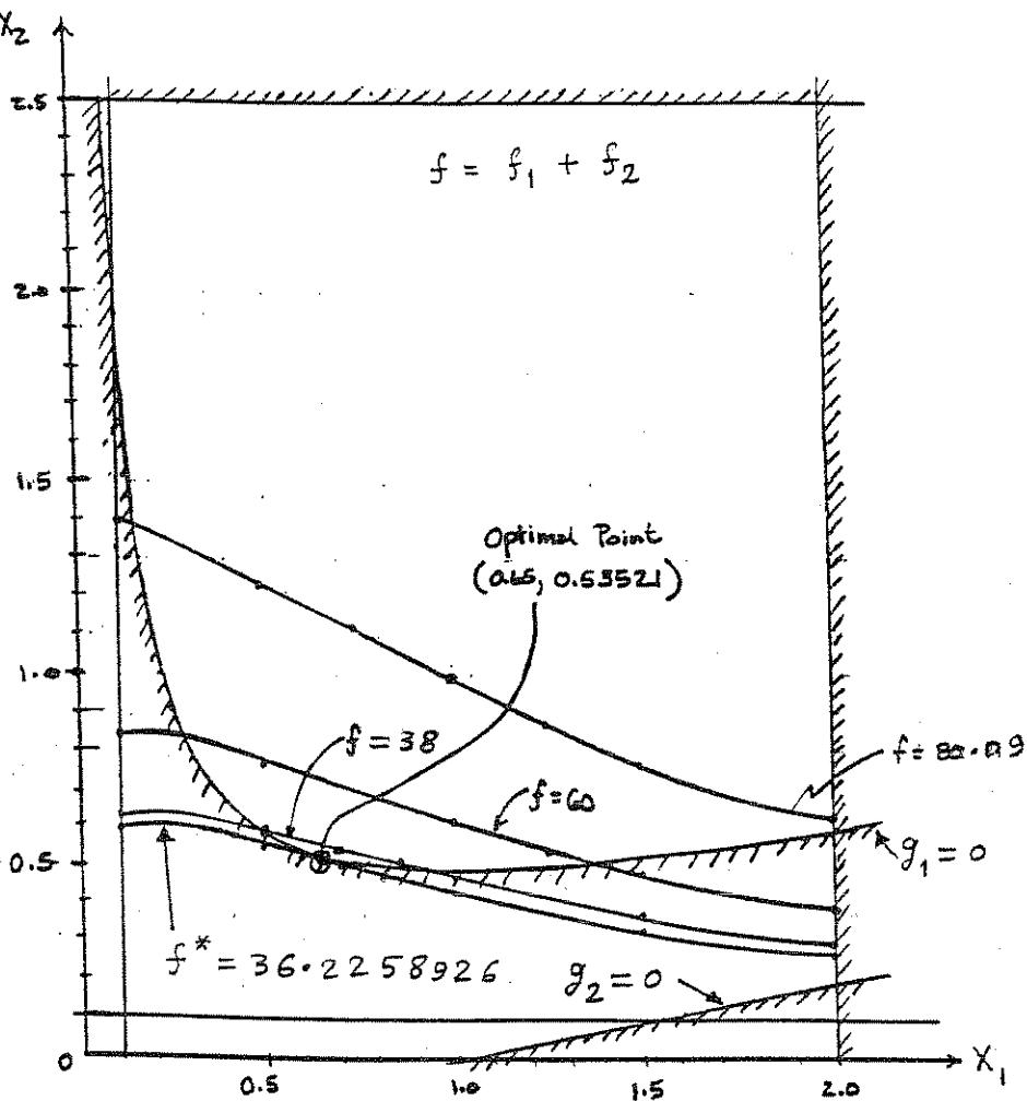
$$(c) f_1(\vec{x}) + f_2(\vec{x}) \\ = 56.6 x_2 \sqrt{1+x_1^2} + \frac{0.01178511 (1+x_1^2)^{1.5} \sqrt{1+x_1^4}}{x_1^2 x_2} \quad (6)$$
